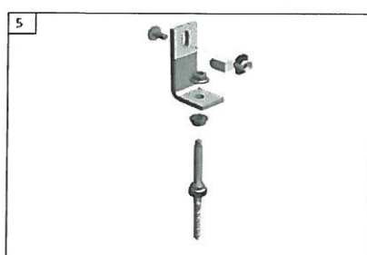
Śruba mocująca z gwintem podwójnym
